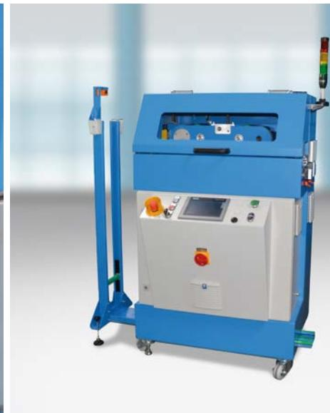
**Geeignet zum kontinuierlichen Abzug von Gummiprofilen (mit – und ohne Stahlarmierung), Schläuchen oder Kunststoffprofilen.**
